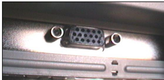
Figura 6. Conector exterior para transmitir la información entre monitor y tarjeta de vídeo
