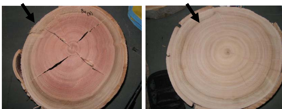
Figuras N° 2 -3 Diferencia albura duramen en secciones de algunos de los ejemplares estudiados
