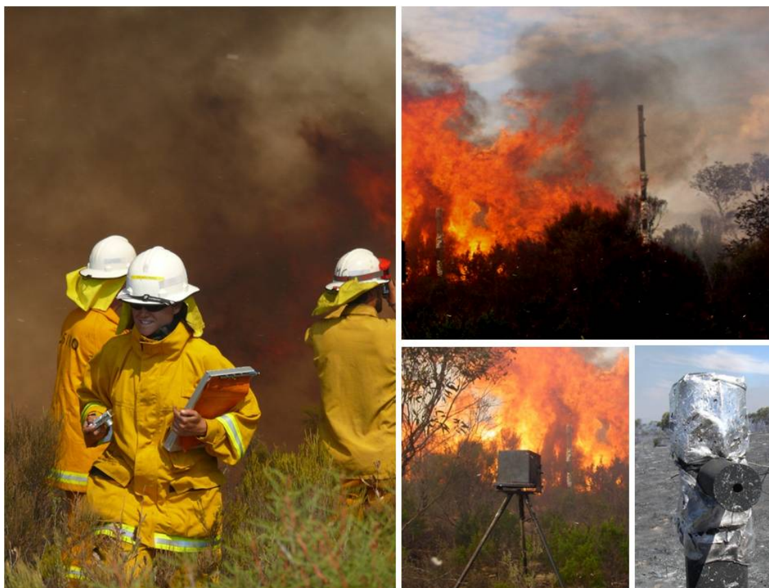
Figura 6. A la izquierda: investigadores realizando observaciones in situ . A la derecha, arriba: torre con sensores de flujo de calor. A la derecha, abajo: cámara de video debidamente protegida y sensor de flujo de calor después del paso de las llamas.
