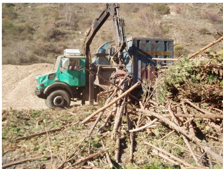
Figura 1: Astillado en patio: astilladora Bruks 802 sobre camión Mercedes Unimog
