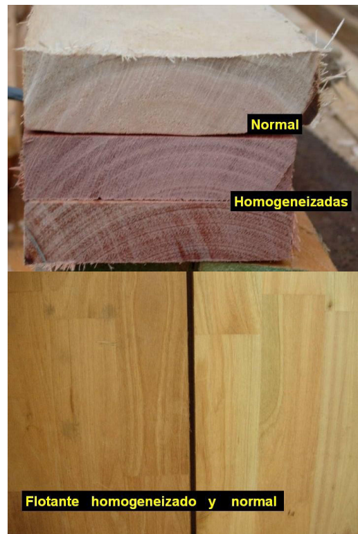
Figura 12: madera común y madera homogeneizada
