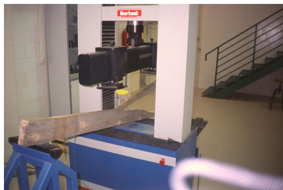
Figura 4.- Ensayo de rotura en la máquina universal de ensayo
