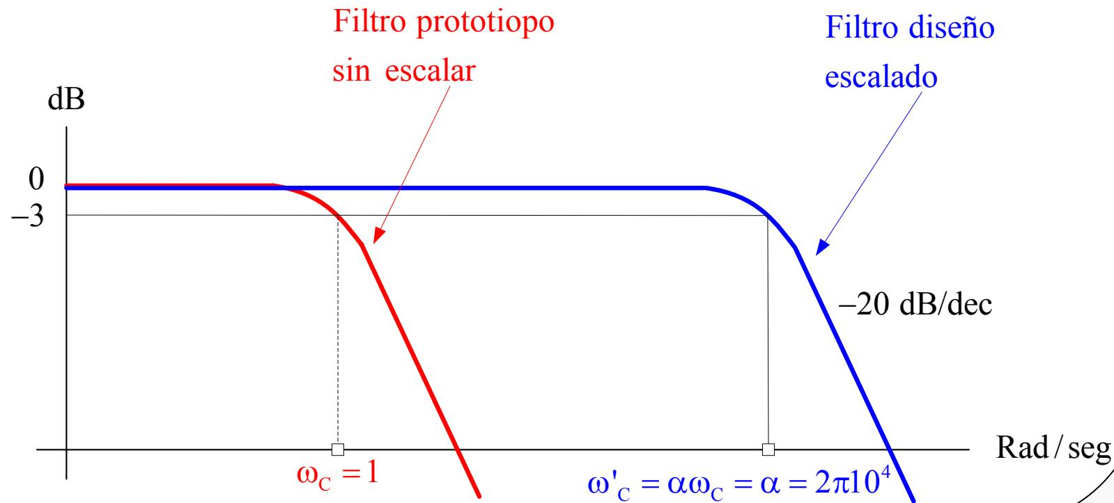
La frecuencia a -3 dB del filtro diseñado es:
