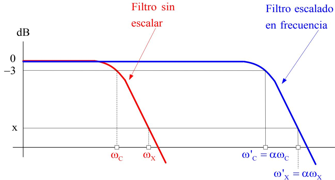
El escalado en frecuencia produce un **desplazamiento hacia la derecha** de la respuesta en frecuencia del filtro sin escalar, de modo que todas las frecuencias quedan multiplicadas por el factor de escalado en frecuencia  $\alpha$ .
