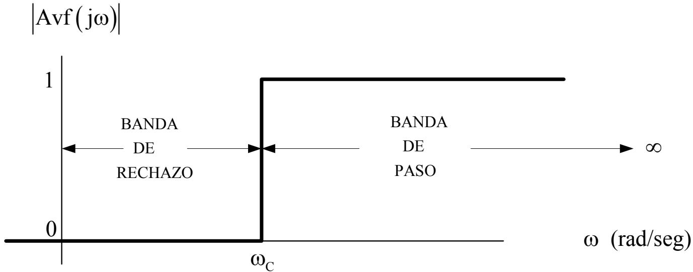
La banda de rechazo está comprendida entre cero y la frecuencia de cruce, y la banda de paso comprende todas las frecuencias superiores a la de cruce.
