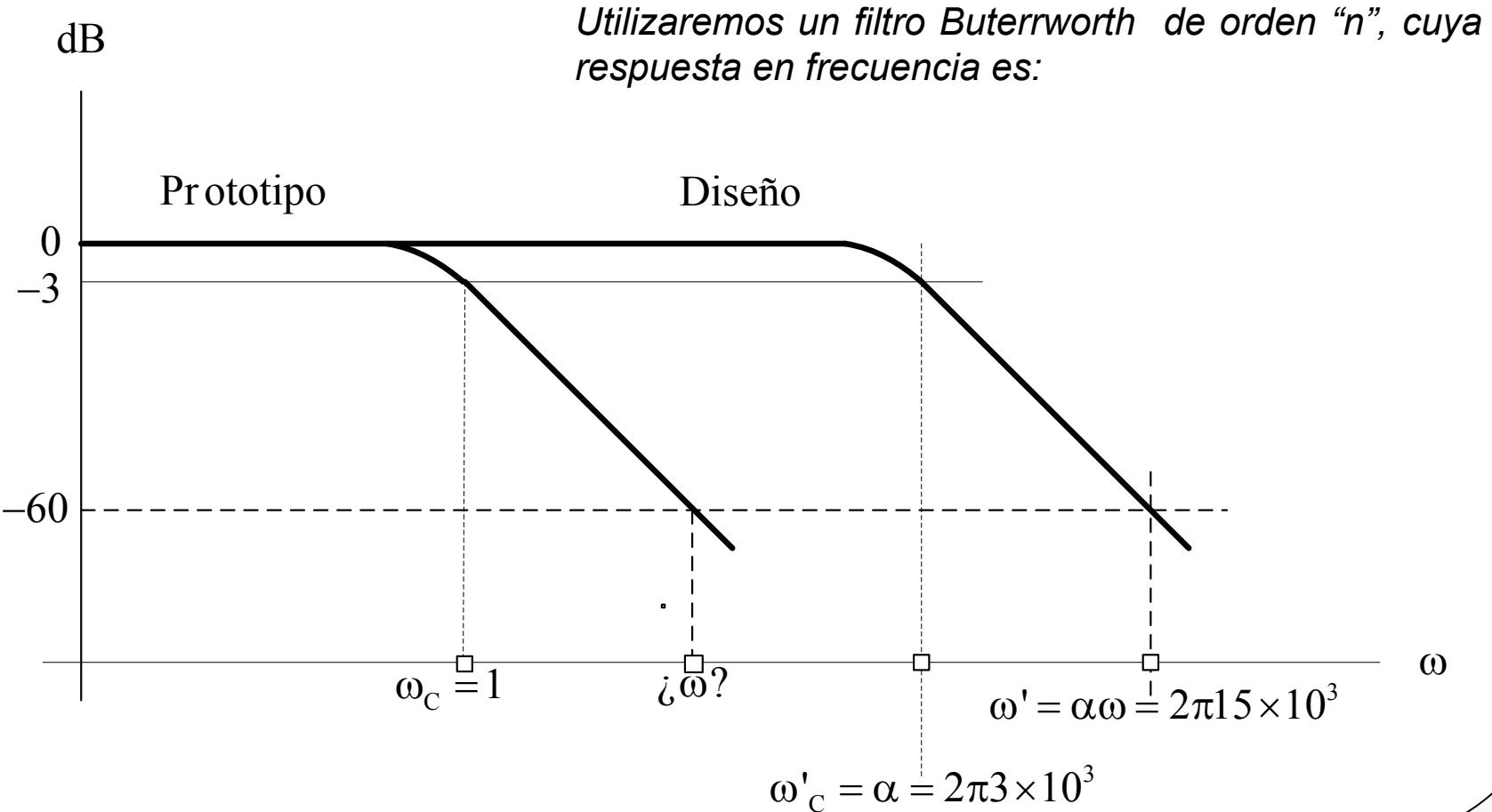
*El primer paso es determinar el valor del orden del filtro prototipo, mediante la ecuación:*
