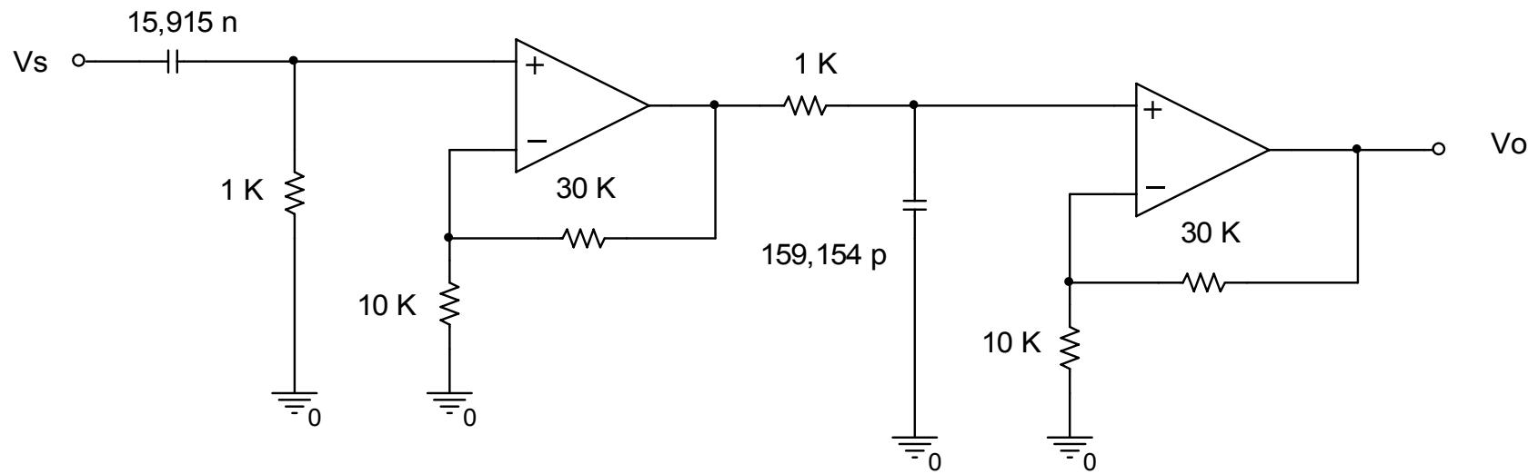
Para diseñar filtros de orden superior a dos, se utilizan filtros normalizados cuyas funciones de transferencia están compuestas a base de funciones de primer orden y de segundo orden.
