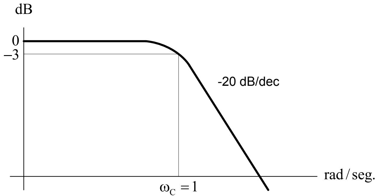
Cualquier tipo de filtro prototipo paso bajo con frecuencia de cruce  $\omega_C = 1 \text{ rad/seg}$  se puede convertir en un filtro prototipo paso alto con  $\omega_C = 1 \text{ rad/seg}$ , utilizando la transformación RC-CR, que consiste en intercambiar las capacidades de 1F por resistencias de 1Ω y las resistencias de 1Ω por capacidades de 1F.
