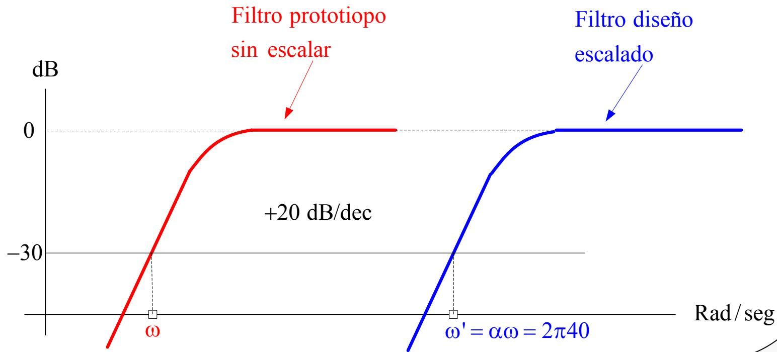
Necesitamos conocer  $\alpha = \frac{\omega'}{\omega} = \frac{2\pi 40}{\omega}$  pero desconocemos el valor de la  $\omega$  del filtro prototipo.
