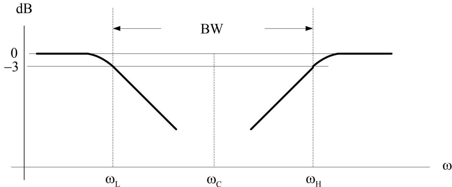
Un filtro de banda eliminada de banda ancha se puede diseñar colocando un filtro paso bajo con una frecuencia de cruce  $f_L$  en paralelo con un filtro paso alto con una frecuencia de corte  $f_H$ .
