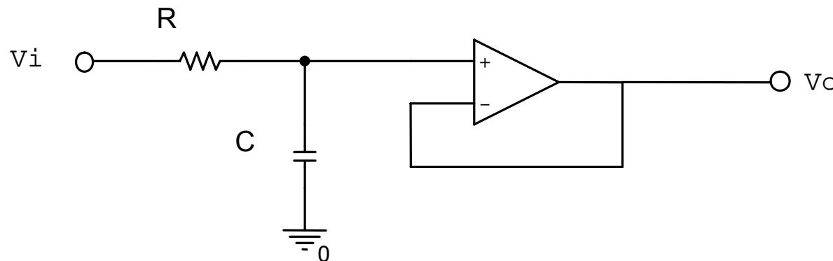
Dado el circuito de la figura anterior, comprobar que un escalado en impedancia no modifica la respuesta en frecuencia del filtro.
