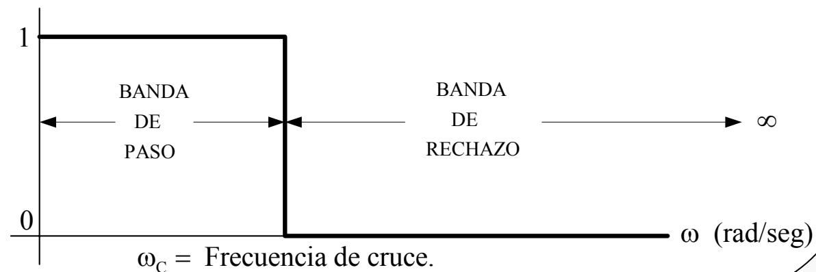
La banda de paso está comprendida entre cero y la frecuencia de cruce, y la banda de rechazo comprende todas las frecuencias superiores a la de cruce.
