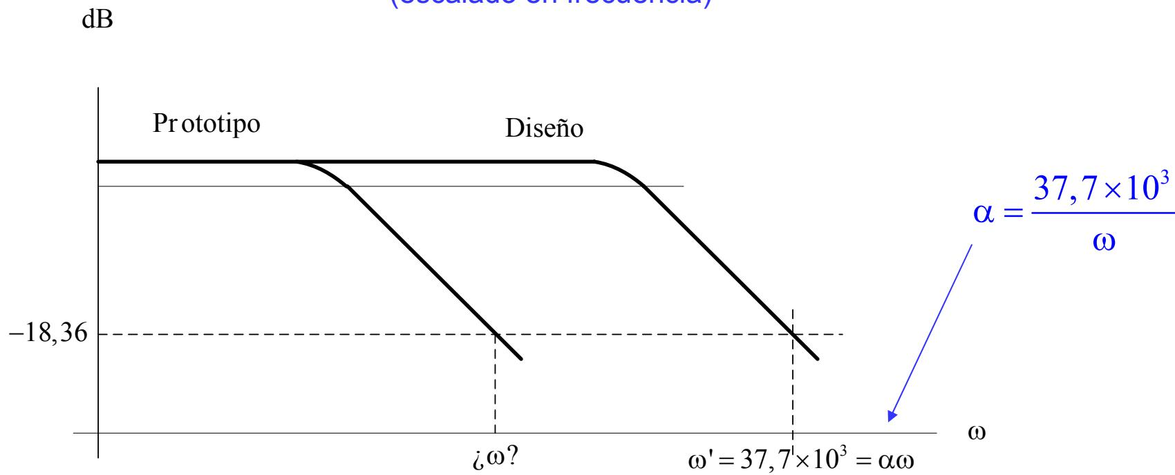
Para hallar el factor de escalado en frecuencia  $\alpha$  necesitamos conocer el valor de la frecuencia  $\omega$  del filtro prototipo para la cual la ganancia vale  $-18.36$  dB. La función de transferencia compleja del filtro prototipo es:
