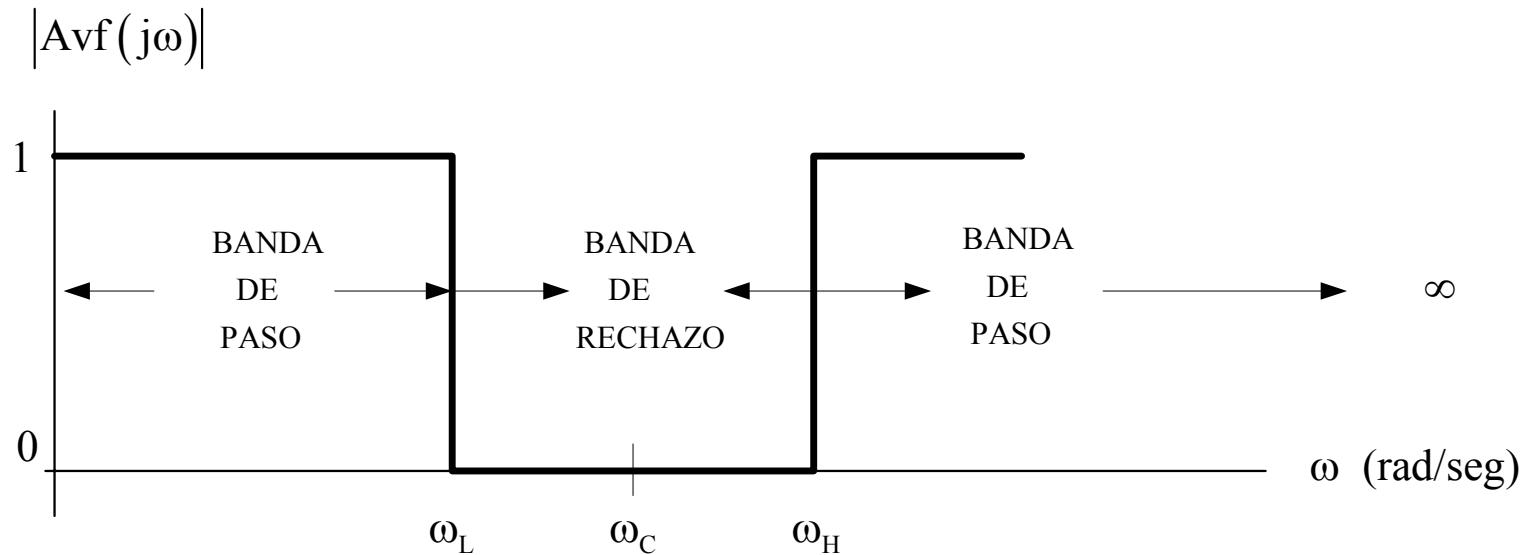
La banda de rechazo está comprendida entre las frecuencias de cruce inferior y superior. Las bandas de paso están comprendidas entre cero y la frecuencia de cruce inferior, y entre la frecuencia de cruce superior e infinito.
