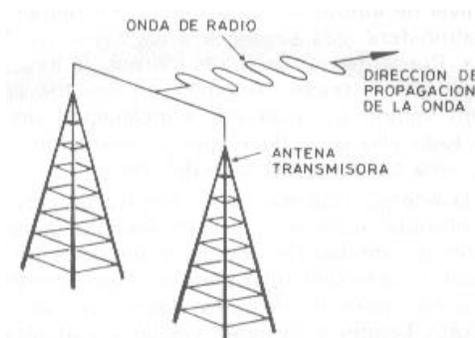
En AM la portadora mantiene la frecuencia constante, variando su amplitud. Las frecuencias comerciales están entre 500KHz – 1600KHz.
