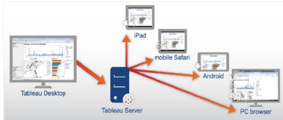
Figura 15. Arquitectura cliente-servidor en Tableau. Fuente: www.intellipaat.com
