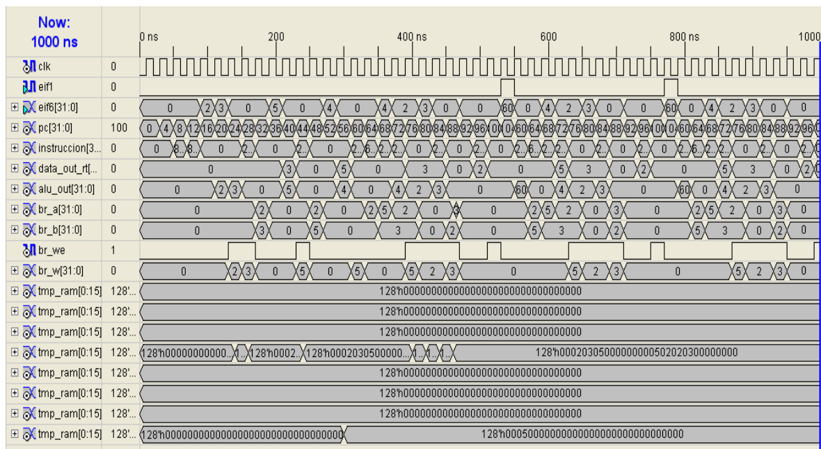
Figura 3.8.- Formas de onda de la simulación de la figura 3.7 en el software de XILINX.
