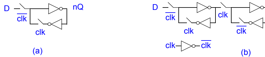
Figura 3.15. Esquema del registro maestro-esclavo convencional. (a) Latch y (b) registro.
