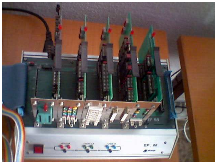
Fig.2. Módulo de expansión BP-88 donde se conectarán las tarjetas de simulación de la serie-88
