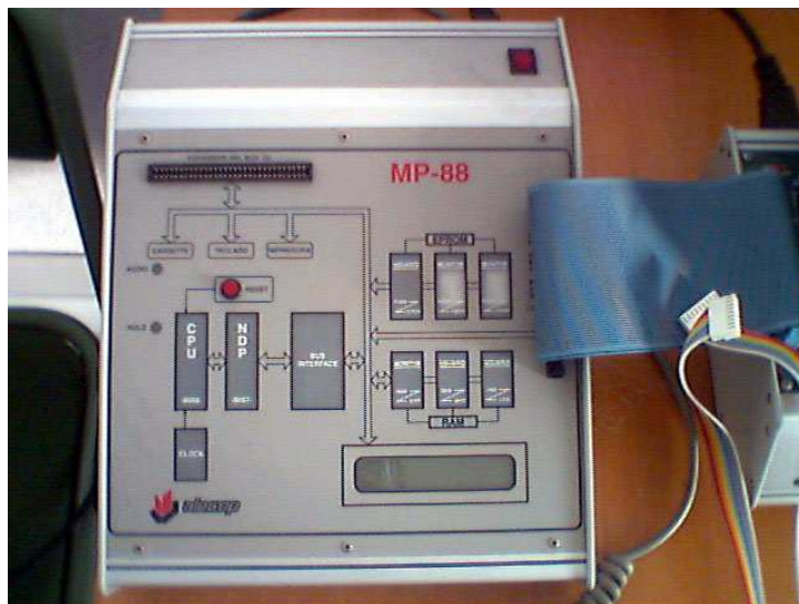
Fig.1. Sistema principal MP-88 donde se conectará el cable de alimentación, el teclado y el módulo de expansión BP-88
