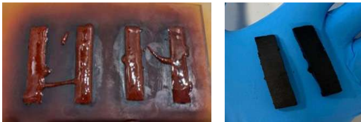
Fig. 11. Biopolímero formulado por la segunda vía con la formulación de referencia con ácido para-toluensulfónico (pTSA.)
