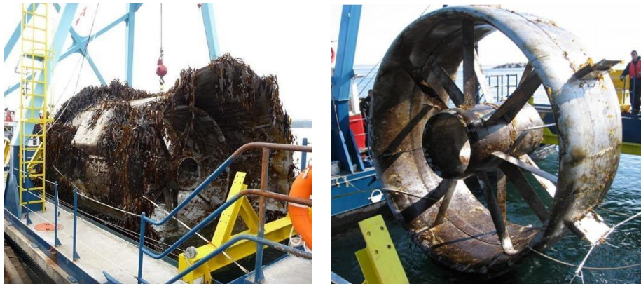
Figura 23 “Efectos del bio-fouling en turbinas mareales”
