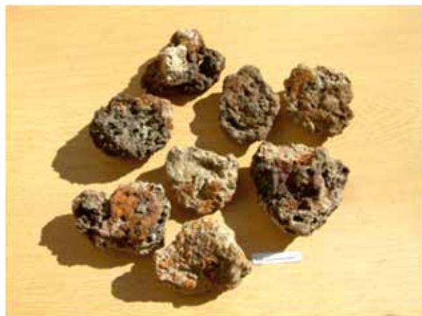
Figura 2. Escorias de forja de fondo convexo
