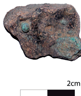
Figura 17 - Cadinho (CACII 3). Note-se a face interna muito escorificada, o nódulo esférico (canto superior esquerdo) e o nódulo disforme (canto inferior direito) analisados por micro espectrometria de fluorescência de raios X, dispersiva de energias.
