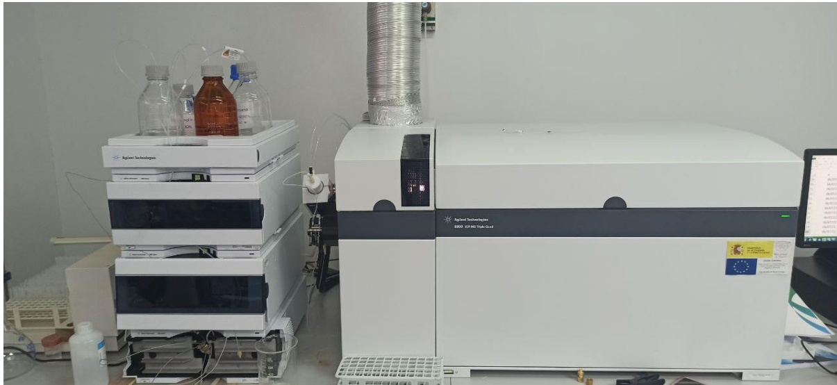
Acoplamiento instrumental UPLC-ICP-MS para análisis de trazas y especiación química de As, Hg, Se y selenoproteínas. Metalómica
